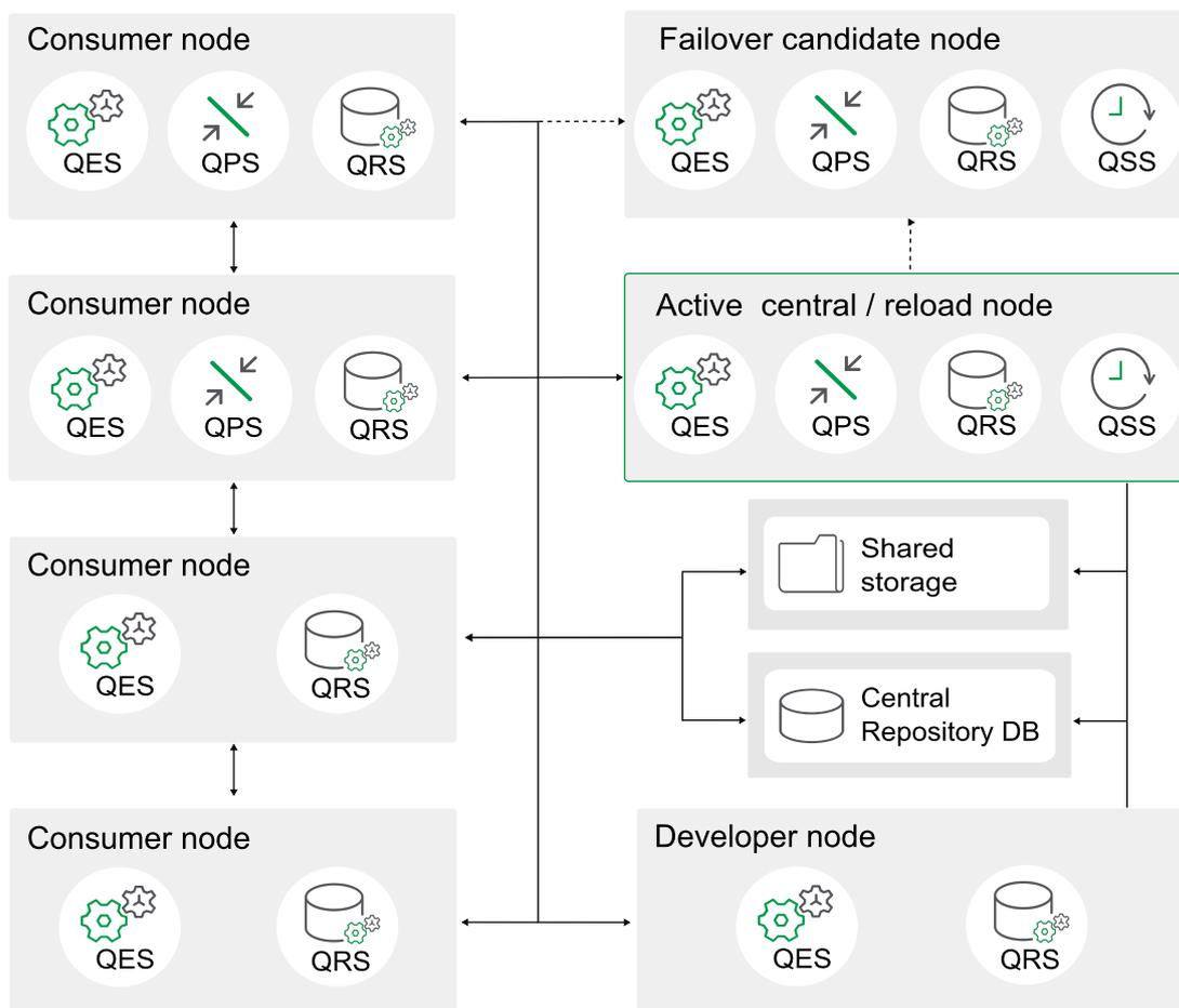
セントラル ノードとフェールオーバー ノードには、すべてのサービスがインストールされている必要があります。ユーザー トラフィックを処理するようにカスタマー ノードにプロキシ サービスを構成します。また、管理 トラフィックを処理するようにセントラルとフェールオーバー ノードの双方にプロキシ サービスを構成します。
